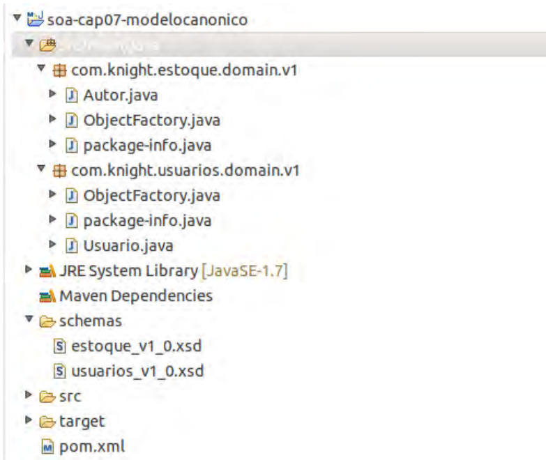
Figura 7.6: Estrutura de classes geradas pelo JAXB
